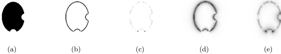
Abbildung 3.5: Salienzkarten für Struktur- und Gabor-Tensoren. (a) zeigt das Eingabebild. Daneben sind die durch das Strukturtensor-Verfahren ermittelten Salienzkarten für Kurven (b) und Kreuzungspunkte (c) zu sehen. (d) und (e) zeigen die entsprechenden Ergebnisse für das Gabor-Verfahren. Hinweis: Die Ergebnisse sind als Beispiele zu sehen und sollten nicht direkt verglichen werden, weil sich die Parameter der Verfahren grundlegend unterscheiden und nicht einfach aufeinander abgestimmt werden können.
